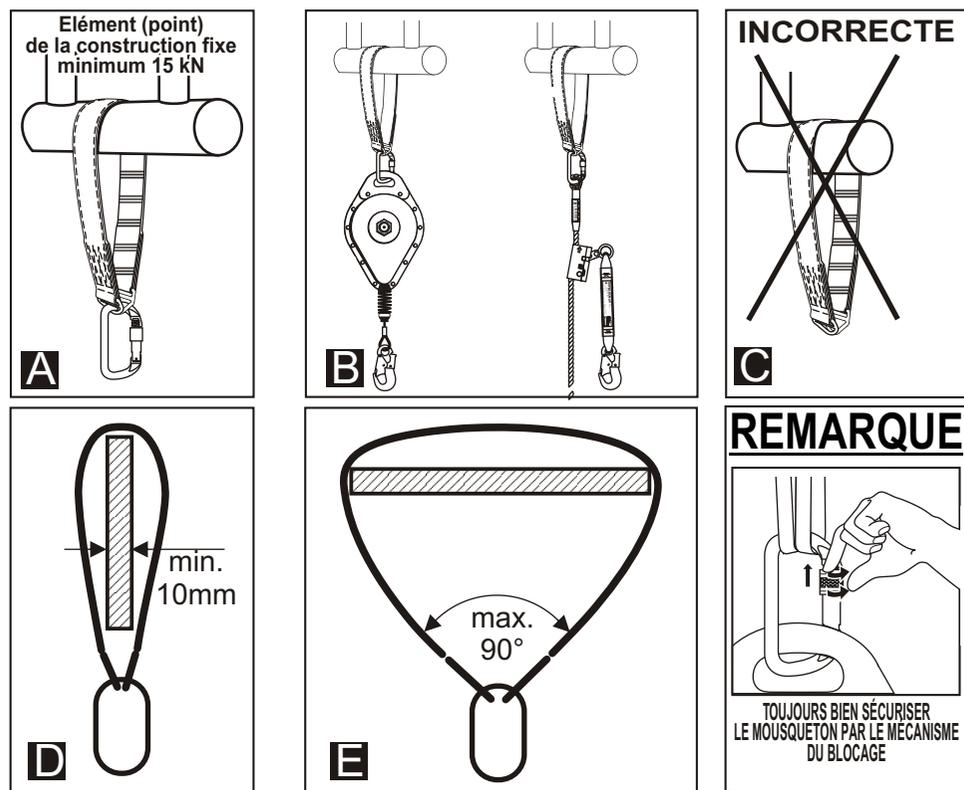
La bande d'attache AZ 700 peut être mise sur les éléments de la construction
