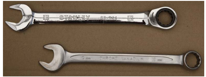
Rysunek 9 - Do montażu wymagane są klucze w rozmiarze "19"
