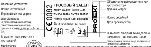
Обозначение даты (месяц и год) проведения очередного осмотра производителем. Использование устройства ежегодного после истечения указанного срока запрещено. Внимание: Перед первым использованием устройства на этикетке 、910Z 🗟 периодического следует отметить дату первого контроля (дата первого использования + 12 месяцев, например, первое использование оборудования – 01.2017; обозначена дата контроля – 01.2018).
